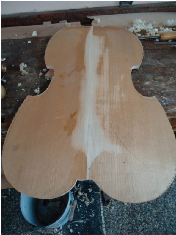
Abb. 19: Aussenseite der geleimten Decke, Foto: S. Schürch.
