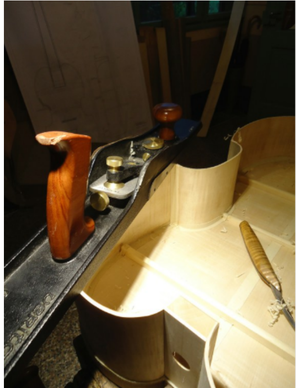
Abb. 16: Hobeln der Zargenhöhe auf die Planmasse. Foto: S. Schürch.
