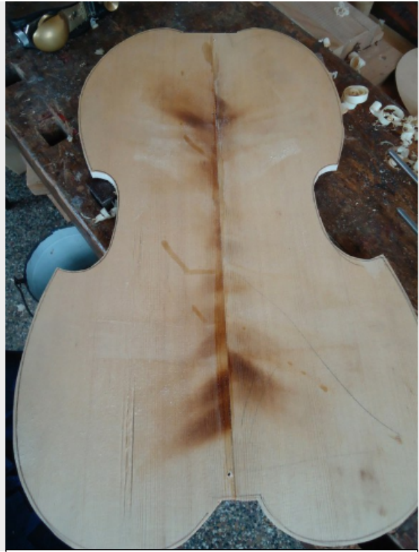
Abb. 20: Innenseite der Decke mit den Brandspuren des Biegeeisens. Foto: S. Schürch.
