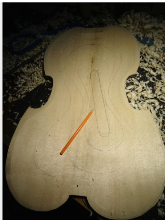
Abb. 24–25: Ausarbeitung der asymmetrischen Deckenstärken. Foto: S. Schürch.
