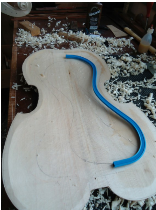
Abb. 24–25: Ausarbeitung der asymmetrischen Deckenstärken. Foto: S. Schürch.
