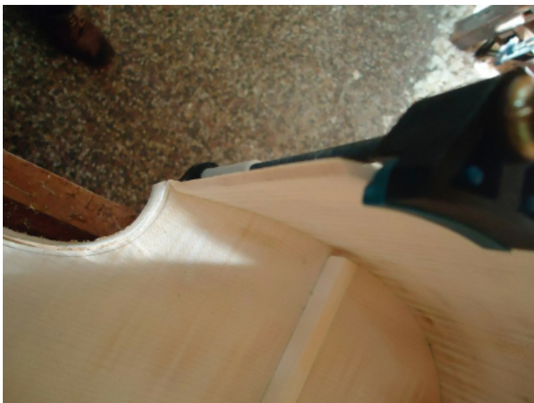
Abb. 7: Eckverbindungen der Zargen auf Gehrung schneiden. Foto: S. Schürch.
