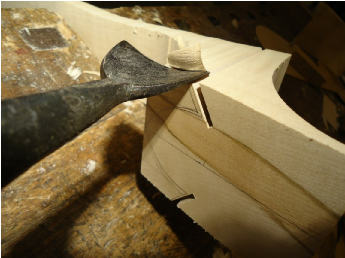
Abb. 9: Formgebung des Halsstocks. Foto: S. Schürch
