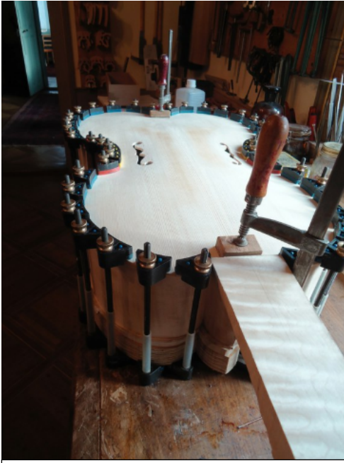
Abb. 26: Das Aufleimen der Decke auf die Zargen. Foto: S. Schürch.
