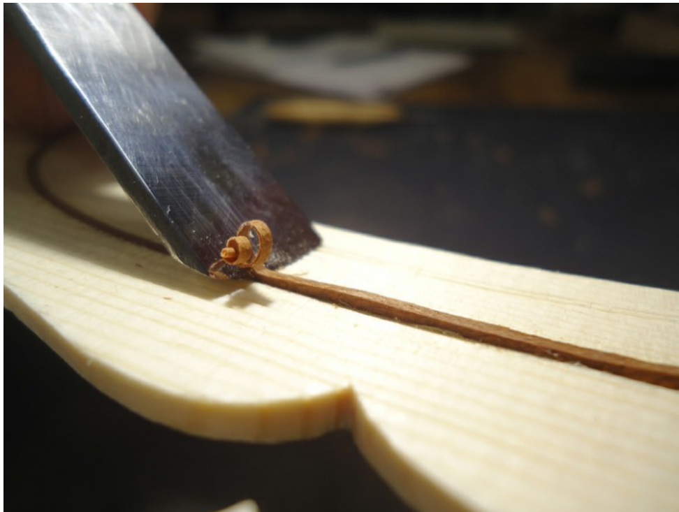
Abb. 28: Das Schneiden eines Einlegespanns auf Deckenhöhe. Foto: S. Schürch.
