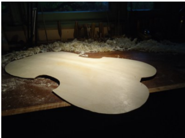
Abb. 21–22: Die fertig gewölbte Decke. Foto: S. Schürch.
