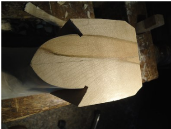
Abb. 10: Endform des Halsstocks (vom Boden aus gesehen). Foto: S. Schürch
