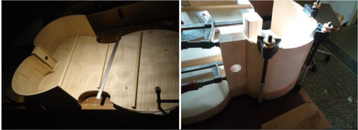
Abb. 5–6: Anprobe und Leimen der Unterzargen auf Boden und Unterklötz. Foto: S. Schürch.
