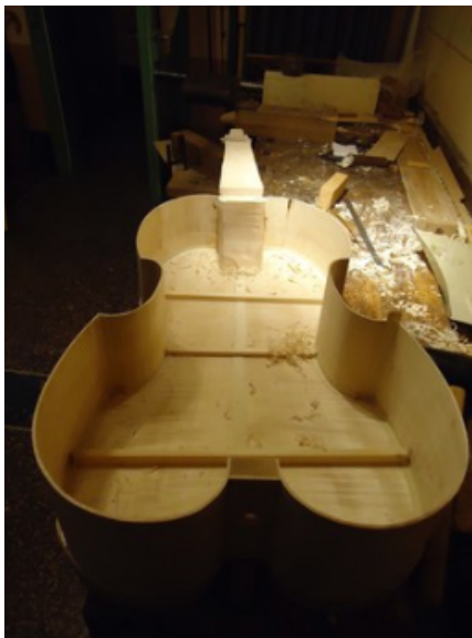
Abb. 17: Fertig verleimter Zargenkranz mit dem Hals. Foto: S. Schürch.
