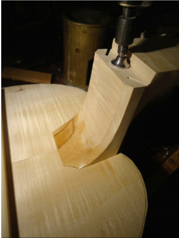
Abb. 15: Aufleimen des Halses. Foto: S. Schürch.
