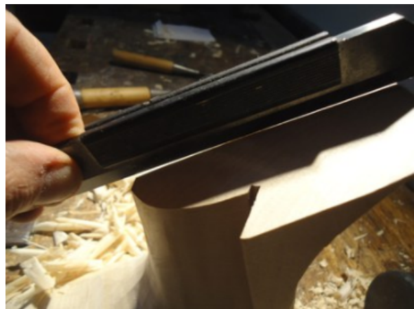
Abb. 11: Anpassen der Leimfläche an den konkaven Bodenwinkel. Foto: S. Schürch
