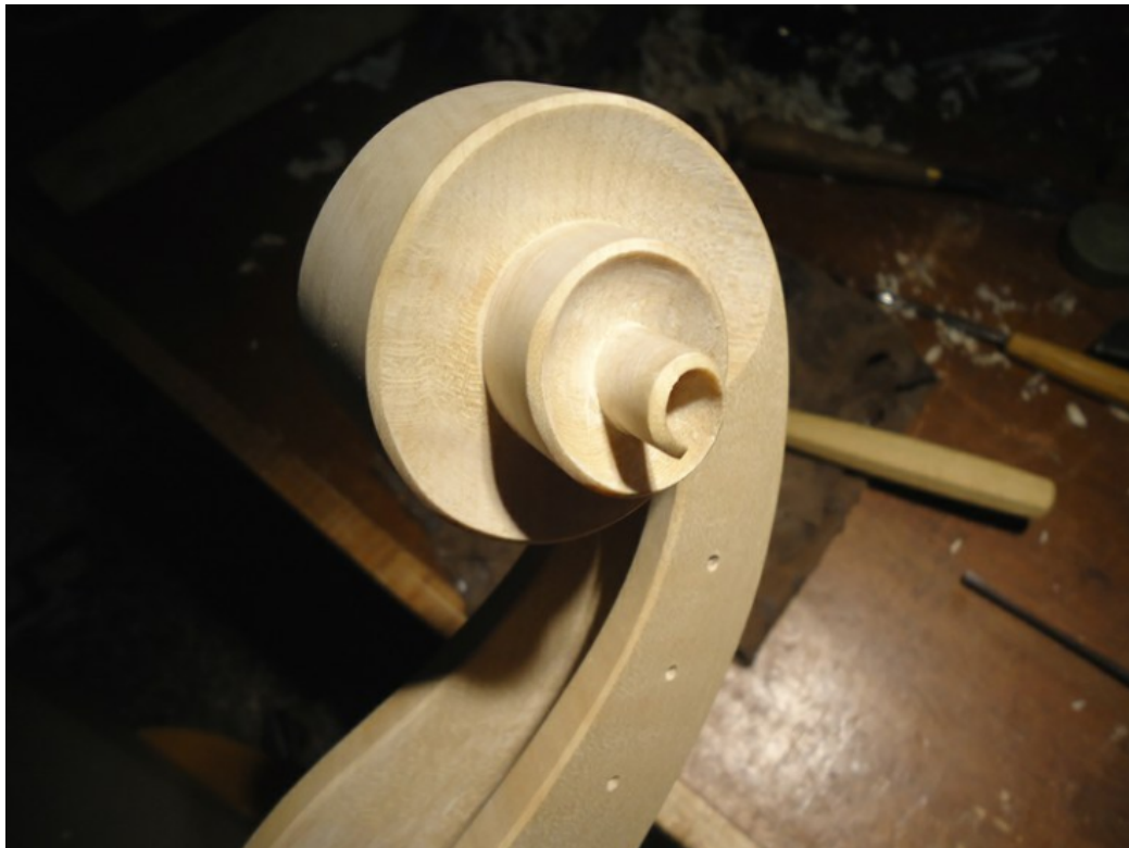
Abb. 14: Fertige Schnecke mit der klar ersichtlichen ausgebohrten innersten Windung. Foto: S. Schürch.
