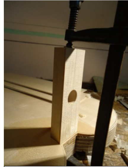
Abb.2: Erster Schritt des Aufschachtelns: Leimen des Unterklotzes. Foto: S. Schürch.
